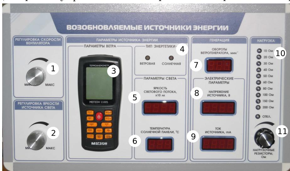
Рис. 2: Органы управления и индикаторы фронтальной панели пульта управления
