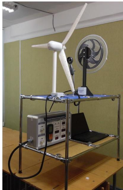
Рис. 4: Стенд в конфигурации изучения ветряной энергетики
